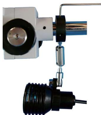
図のように六角レンチで照明用自在アームのネジを緩めると、アームに対する照明装置の取付位置を変えることが出来ます。
