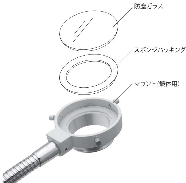
図5:スponジパッキング・防塵ガラスの交換方法
