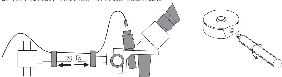
4. 図のようにネジを組み込み、アームを連結します
