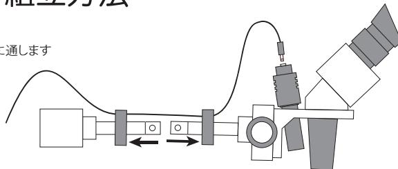
ピラースタンド背面から出るケーブル先端にある照明用プラグをLED照明装置に挿します。
