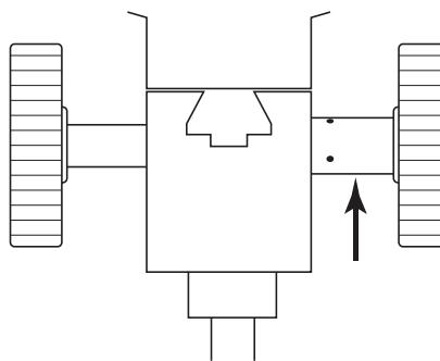
図2:焦点ハンドルトルク調整ネジ
