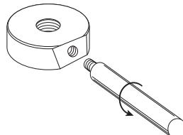
3. 図のようにネジを組み込み、アームを連結します
